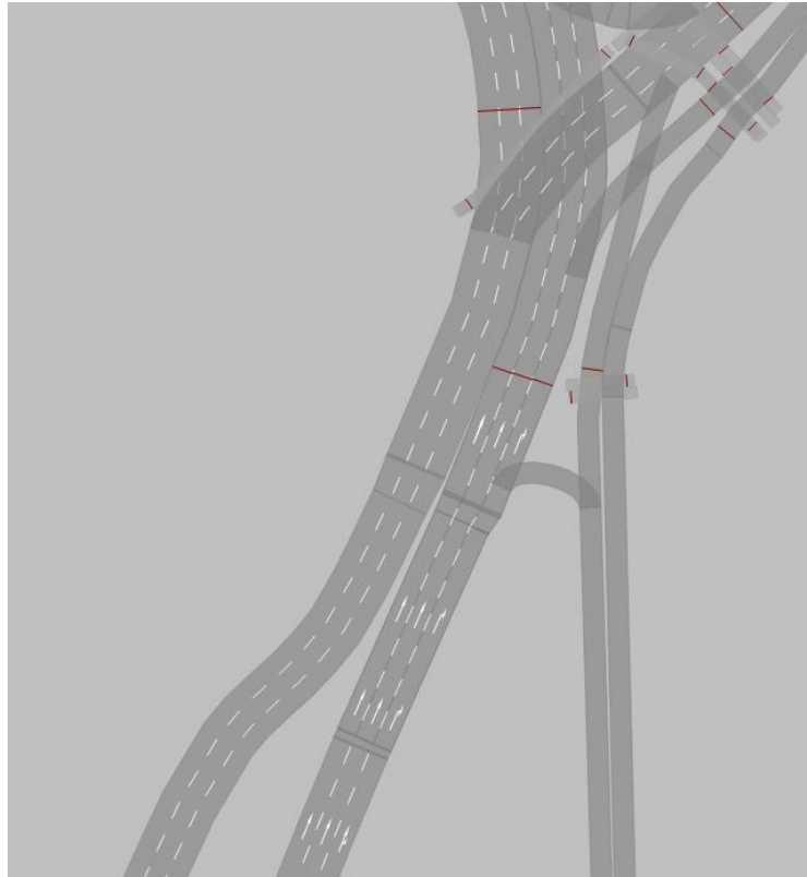
Bild 3.15 Busspur Variante 1d; Verkehrsführung südliche B14 vor der Rechtsabbiegemöglichkeit in die Neckarstr.
